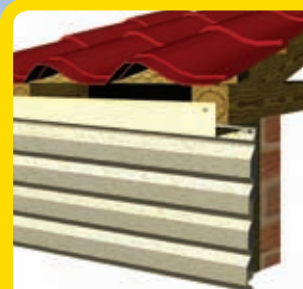
Фасонный элемент –примыкание к кровле
