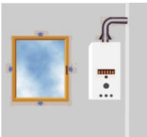
В отличие от отопительных котлов, обслуживающих целое здание, и устанавливаемых обычно в отдельных помещениях, индивидуальные газовые теплогенераторы довольно часто монтируются сегодня непосредственно в квартире. При этом должно быть гарантировано поступление достаточного количества приточного воздуха в это жилое помещение.
